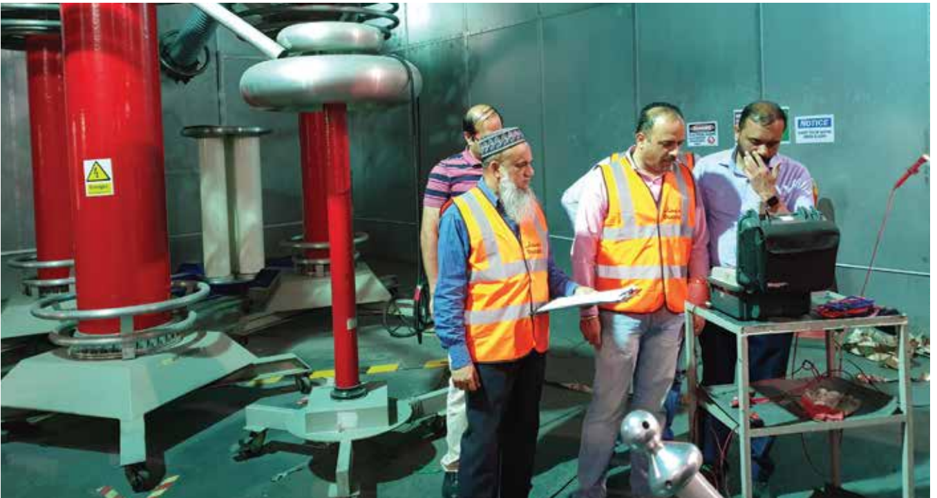
০৪ জুন ২০১৯ তারিখ অতিরিক্ত প্রকল্প পরিচালক (ইলেকট্রিক্যাল, সিগন্যাল এন্ড টেলিকমিউনিকেশন এন্ড ট্র্যাক), MRT Line-6 Ducab Cables Factory, UAE-তে 33kv Cables-এর High Voltage Test প্রত্যক্ষ করেন
